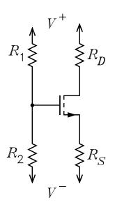
$$V_{GG} := \frac{V_{plus} \cdot R_2 + V_{minus} \cdot R_1}{R_1 + R_2}$$
