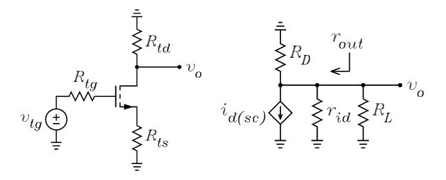
$$G_{mg} := \frac{1}{r'_{s} + R_{p}(R_{ts}, r_{0})} \cdot \frac{r_{0}}{r_{0} + R_{ts}}$$
